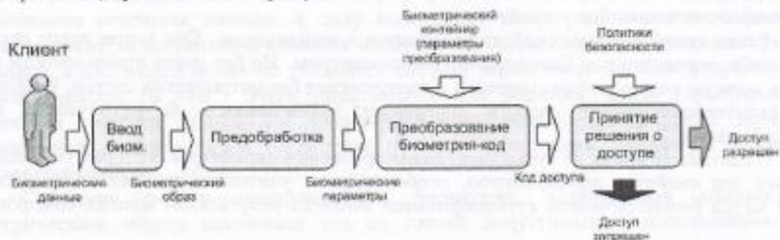
Рисунок 3 - Модель высоконадежной биометрической аутентификации
